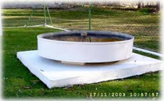
Tanque de evaporación
